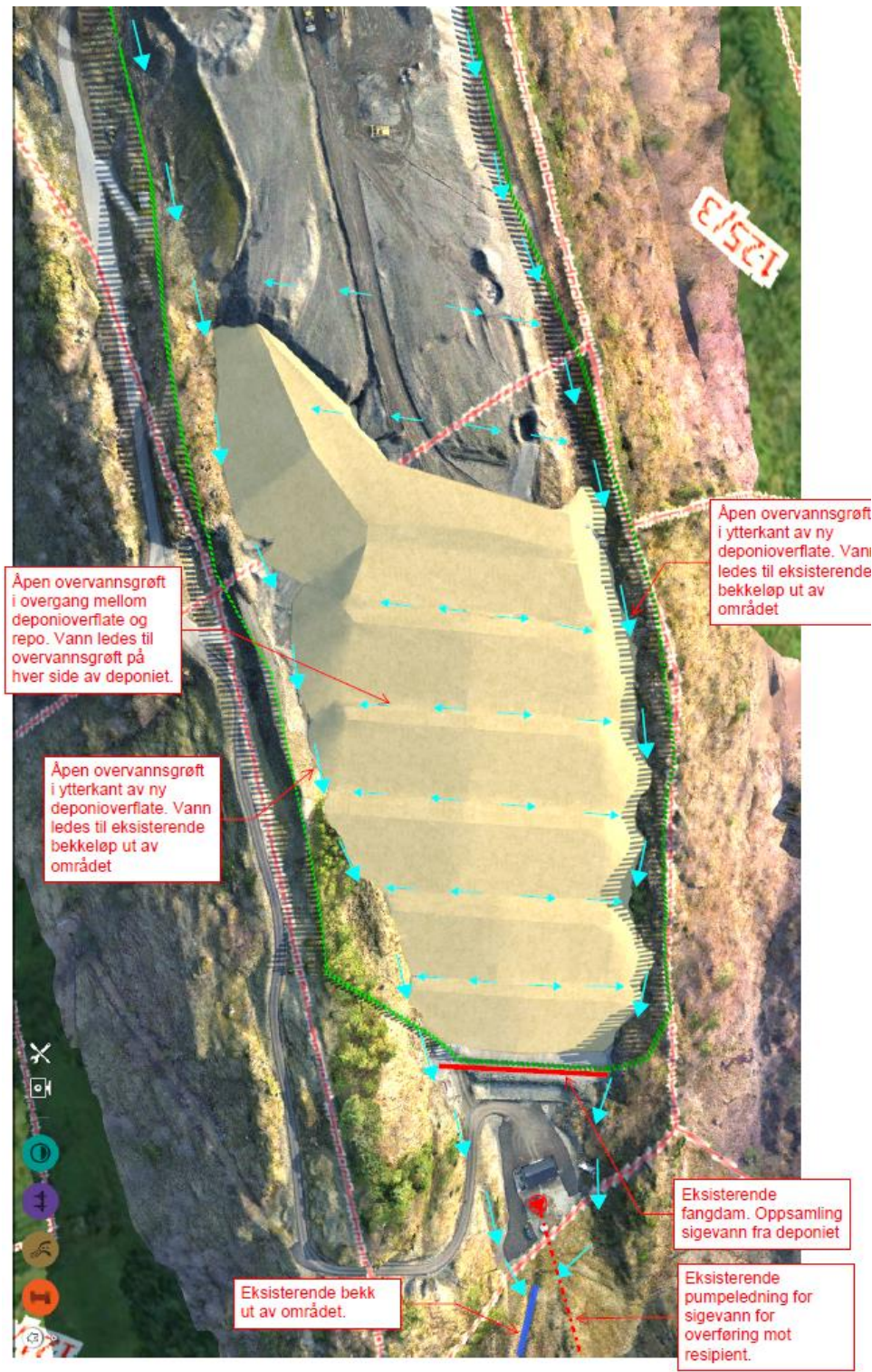
Figur 6 Generelle prinsip for håndtering av overvann for alternativ 1A-3B.
