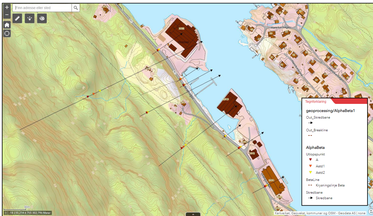
Figur 24: Alfa-Beta-beregning av utløpslengder for steinsprang (NVE AlfaBeta). Skredbanen er vist med sort linje og starten av linjen er utslippspunktet. Trekkanter viser utløpslengder for steinsprang.
