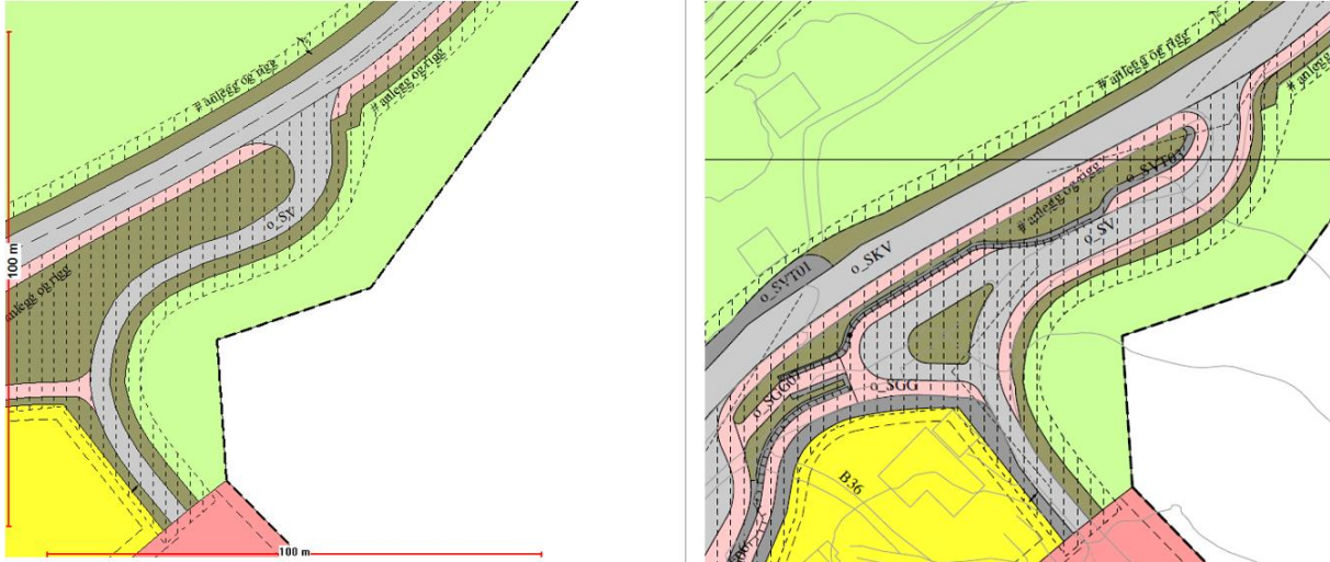
Figur 2 Bilete til venstre visar gjeldande plan. Bilete til vestre visar endringa med flytta «kyss og køyr»-løysing, med tilkomstveg og fortâu langs o_SV.
